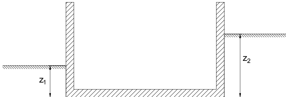
Σχήμα 3.2. Ενδεικτική διατομή κτηρίου για τον προσδιορισμό του βάθους έδρασης πλάκας επί εδάφους με διαφορετικές στάθμες έδρασης λόγω κεκλιμένου εδάφους.
